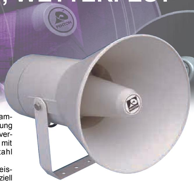
PH 30/T & PH 30/TC sind kompakte, wetterfeste Druckkammerlautsprecher, die besonders für eine hohe Tonverstärkung konzipiert wurden. Sie werden aus einem UV-beständigen, verstärkten ABS-Kunststoff hergestellt und verfügen über einen mit Epoxid überzogenen U-Befestigungsbügel aus Edelstahl (rostfrei).
